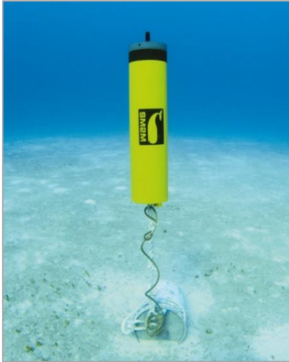
Fotografia 1. Urządzenie SM2M, Wildlife Acoustics, Bio-acoustic Monitoring Systems
